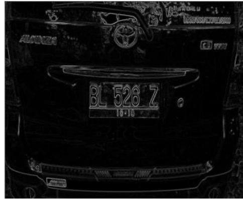
Gambar 4.3 Deteksi Tepi Sobel
