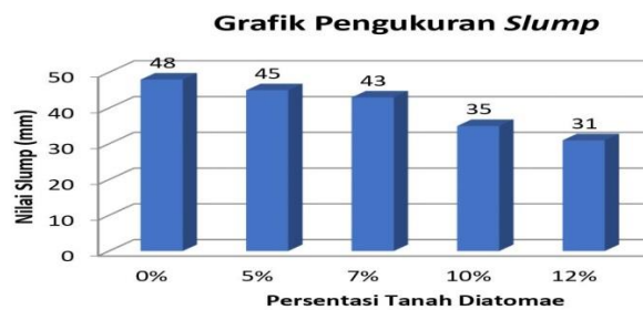
Gambar 2. Grafik pengukuran Slump test pada substitusi tanah diatomae
