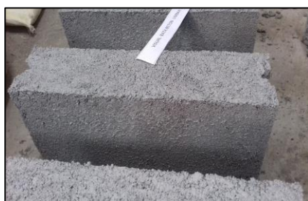
Bata Beton Limbah 1 : 3 : 3
