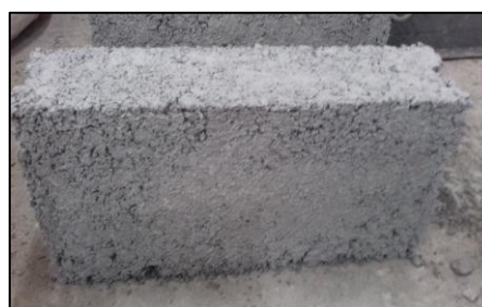
Bata Beton Limbah 1:2:4
