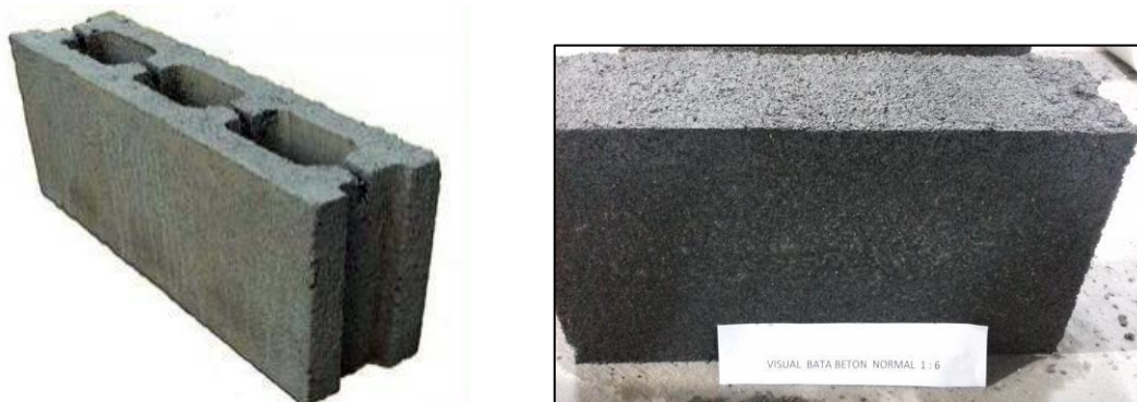
Gambar 3. Bata beton berlubang dan Bata Beton Pejal
