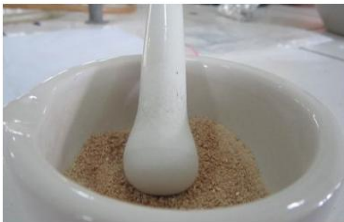
Gambar : 2. Hasil Ekstraksi Keratin dari Limbah Bulu Ayam
