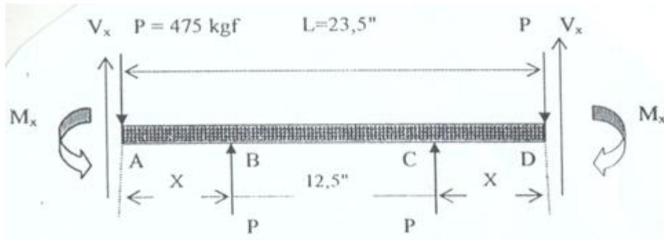
Gambar 3. Diagram gaya pada mekanis me poros pompa sentrifugal
